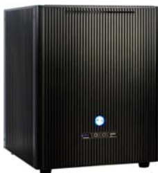
TES WS-I G3: Leistungsstarker Multimedia-Cube aus 4.5mm Aluminium mit internem Netzteil.
